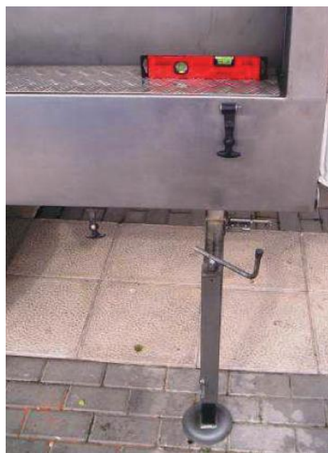
Figura 17: Nivelando la planta
