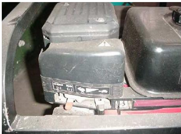
Figura 22: Generador: Regulador de velocidad
